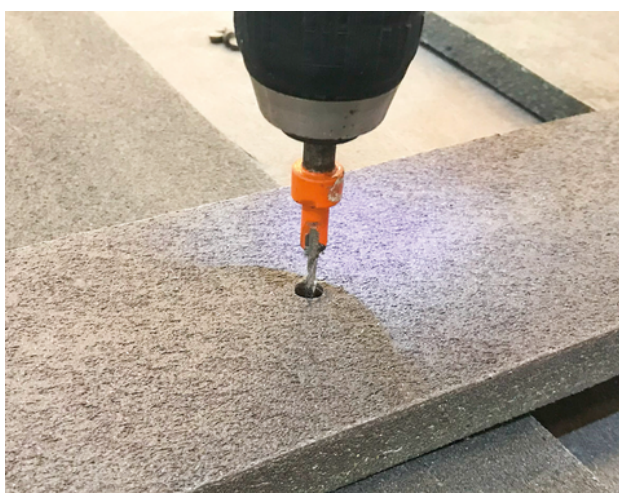
FIGURAS 9 E 10 - PROCESSO DE FURAÇÃO.
